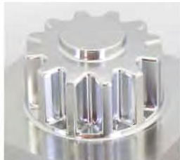
工件尺寸 : 50×50mm (加工深度18.2mm) Work size : 50×50×18.2mm
