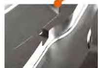
刀具磨损量 0.010mm Tool wear
